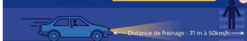
D'après une expérience menée par la Sécurité routière chez UTAC (Union Technique de l'Automobile, du motocycle et du Cycle), les piétons vêtus d'une tenue rétro réfléchissante sont visibles de nuit dans les phares d'une voiture à 44 mètres et les cyclistes à 63 mètres contre respectivement 28 mètres et 35 mètres avec une tenue sombre.
